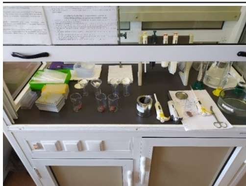
Рисунок 4 – Этапы пробоподготовки. Внесение стандарта в гомогенат печени свиньи.
